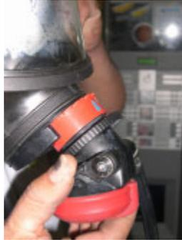
blocco erogatore DRÄGER
